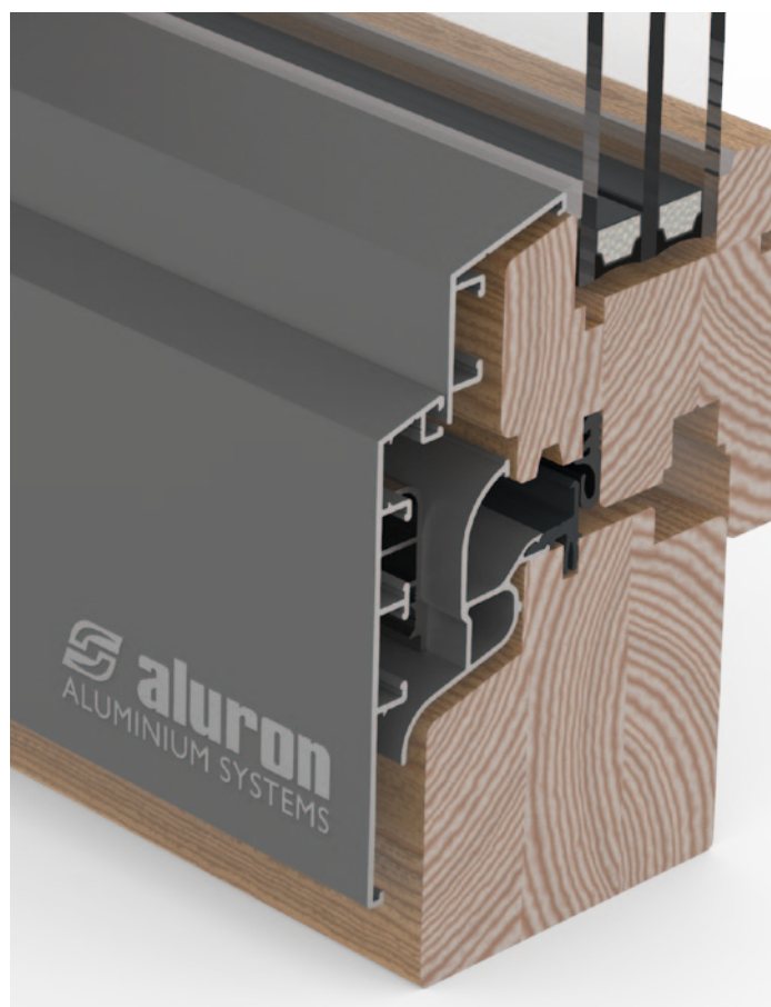
Warianty połączenia naroży: 45° - standard produkcyjny Aluron, 90° - opcjonalnie, do samodzielnego montażu
